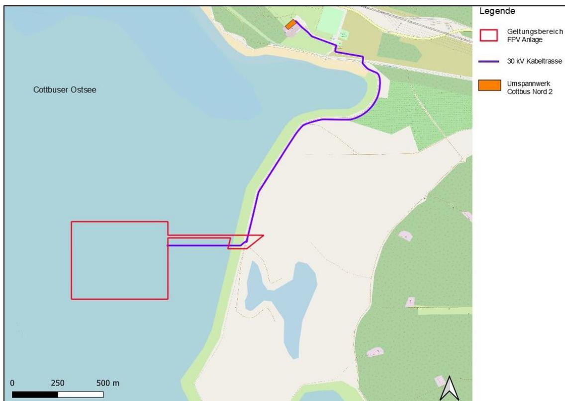
Abbildung 41: Verlauf der Kabeltrasse (KT) entlang des vorhandenen Wegesystems am Ufer | Quelle: LEAG/EPNE
