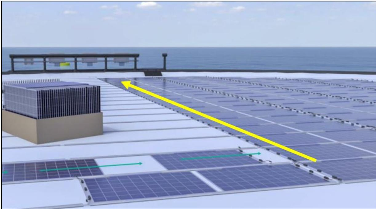
Abbildung 35: Skizze Kabelführung, der gelbe Pfeil zeigt die Ausrichtung der Module anhand der Kabelkanäle | Quelle: bearbeitet nach Ocean Sun AS
