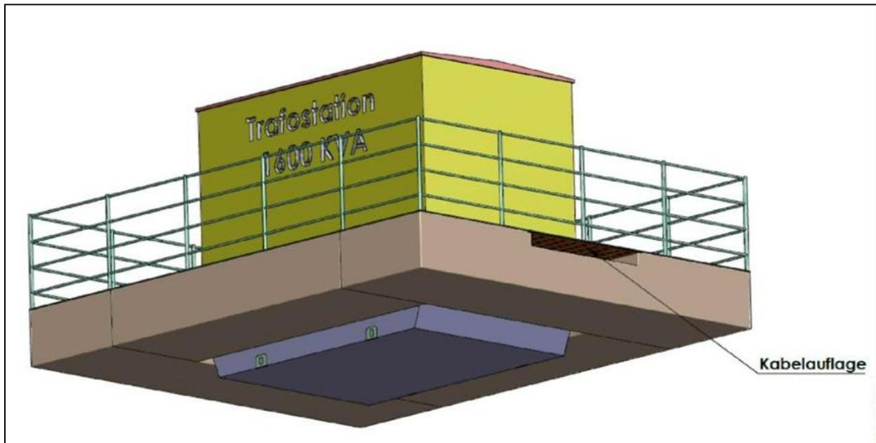
Abbildung 20: Schematische Darstellung Kabelgänge bei den Transformatorenbooten | Quelle: Gsun GmbH
