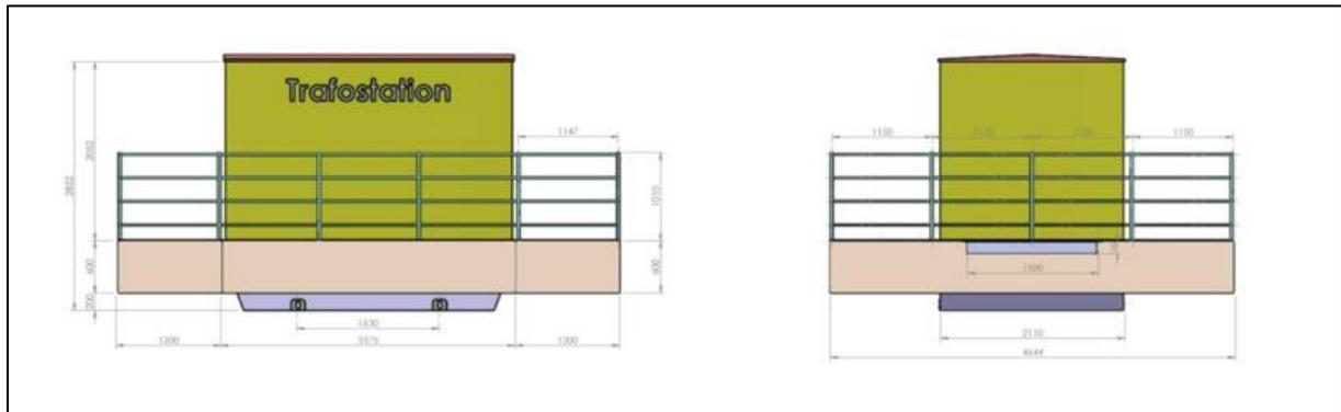
Abbildung 18: Schematischer Aufbau der Transformatorstation auf dem Schwimmkörper | Quelle: Gsun GmbH
