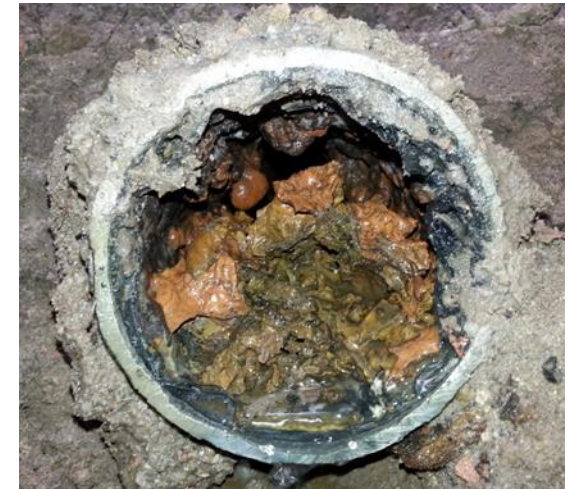
Duktils Guss Eisen GGG, zwischen 29 u. 36 Jahren alt
