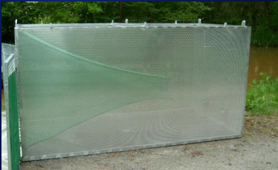
Lochblechkastenreuse, links in fangfähig am Großen Sprewehr Cottbus
